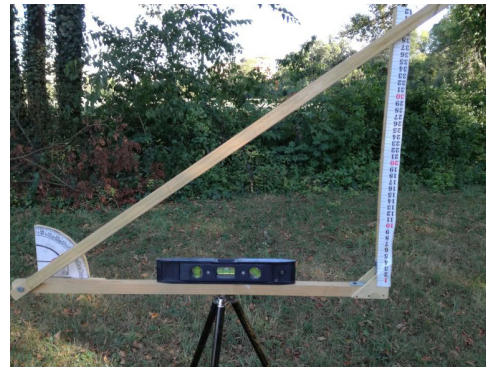
Figura 1. Il clinometro costruito con materiali poveri.
